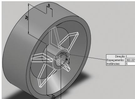
Figura 8.11 – Peça com nervuras de apenas um lado
