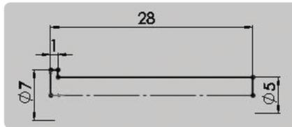
*Figura 9.11 - Esboço do Parafuso da roda da frente*
