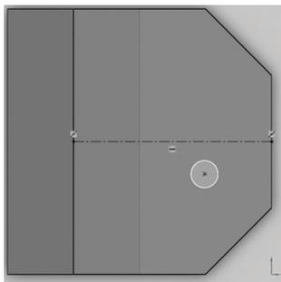
*Figura 5.3 – Linha de centro para posicionar o furo*
