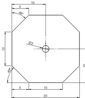
Figura 2.1 – Medidas da peça “Roda de trás”<sup>14</sup>
