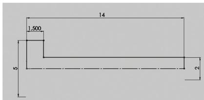
*Figura 9.13 - Esboço do Parafuso da guia da chapinha da direção*
