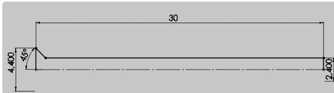
*Figura 9.7 – Esboço do Parafuso do suporte do chassi*
