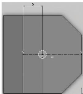
*Figura 5.4 – Dimensionando para posicionar o furo*
