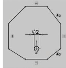
4.3 Dimensione o comprimento total da peça clicando nas duas linhas verticais e dimensione-o com 20 mm.
