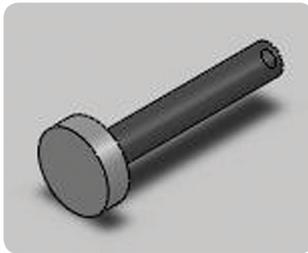
*Figura 9.12 - Parafuso da guia da chapinha da direção*
