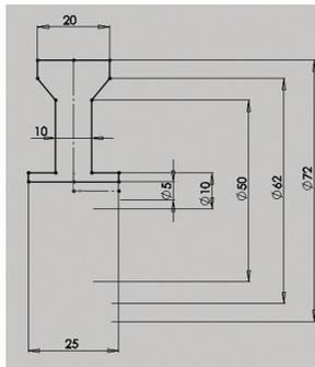
*Figura 8.15 – Esboço da Roda da frente*
