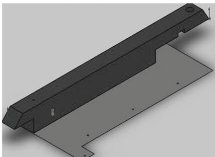
*Figura 10.11 – Assoalho e Chassi do lado posicionados*
