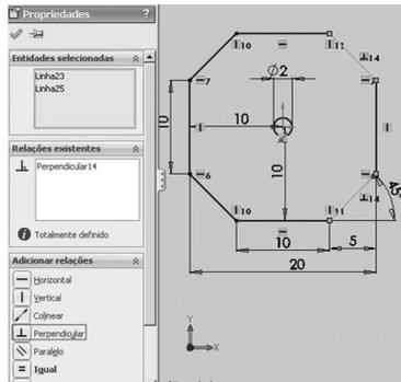
*Figura 2.13 – Adicionando a relação perpendicular*
