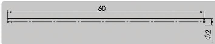
*Figura 9.9 – Esboço do Parafuso do suporte da roda da frente*
