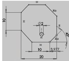
4.7 Dimensione o comprimento do chanfro, clicando na linha do chanfro e levando o ponteiro do mouse para baixo, até a linha de cota ficar na horizontal. Dimensione-o com 5 mm.
