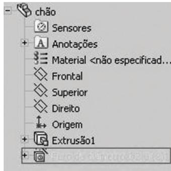
Figura 6.5 – Selecionando o recurso para o Padrão linear na Árvore da peça
