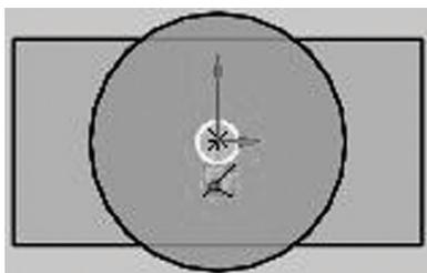
*Figura 4.5 – Posicionando o furo no centro da peça*
