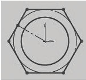
*Figura 7.5 - Desenho da linha de centro para posicionar o esboço*
