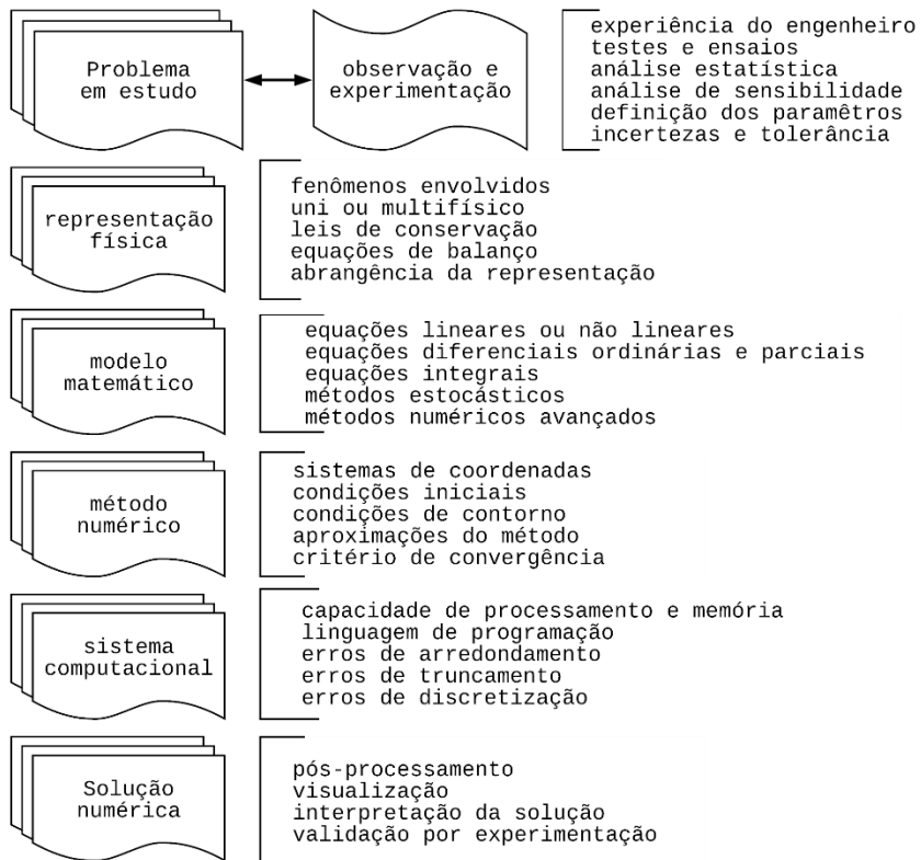
Figura 1. Metodologia de modelagem numérica – processo iterativo.
