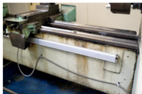
Detalhes da instalação das réguas potenciométricas no laboratório.
