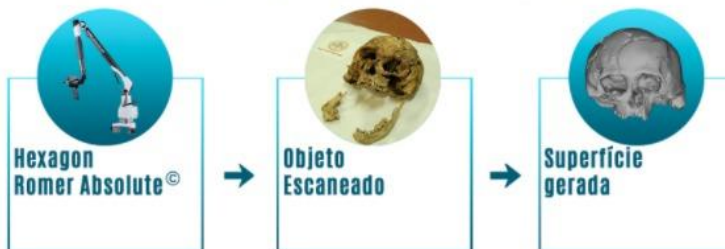
Figura 2 - Sequência de etapas para digitalização tridimensional de um produto.
