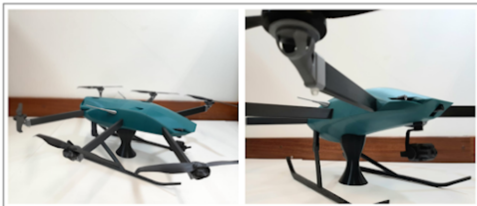
Figura 2 - Mock-up de drone em escala reduzida (1:2), utilizando PLA e resina
