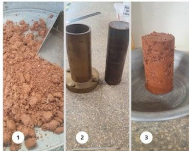
Figura 2 - 1) Mistura manual da fibra e cal ao solo; 2) Cilindro de Harvard; 3) CP de 10 cm de altura por 5 de diâmetro.
