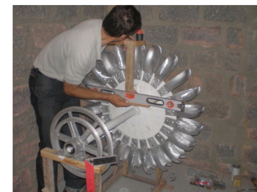
Fig. 8- Montagem e Alinhamento
