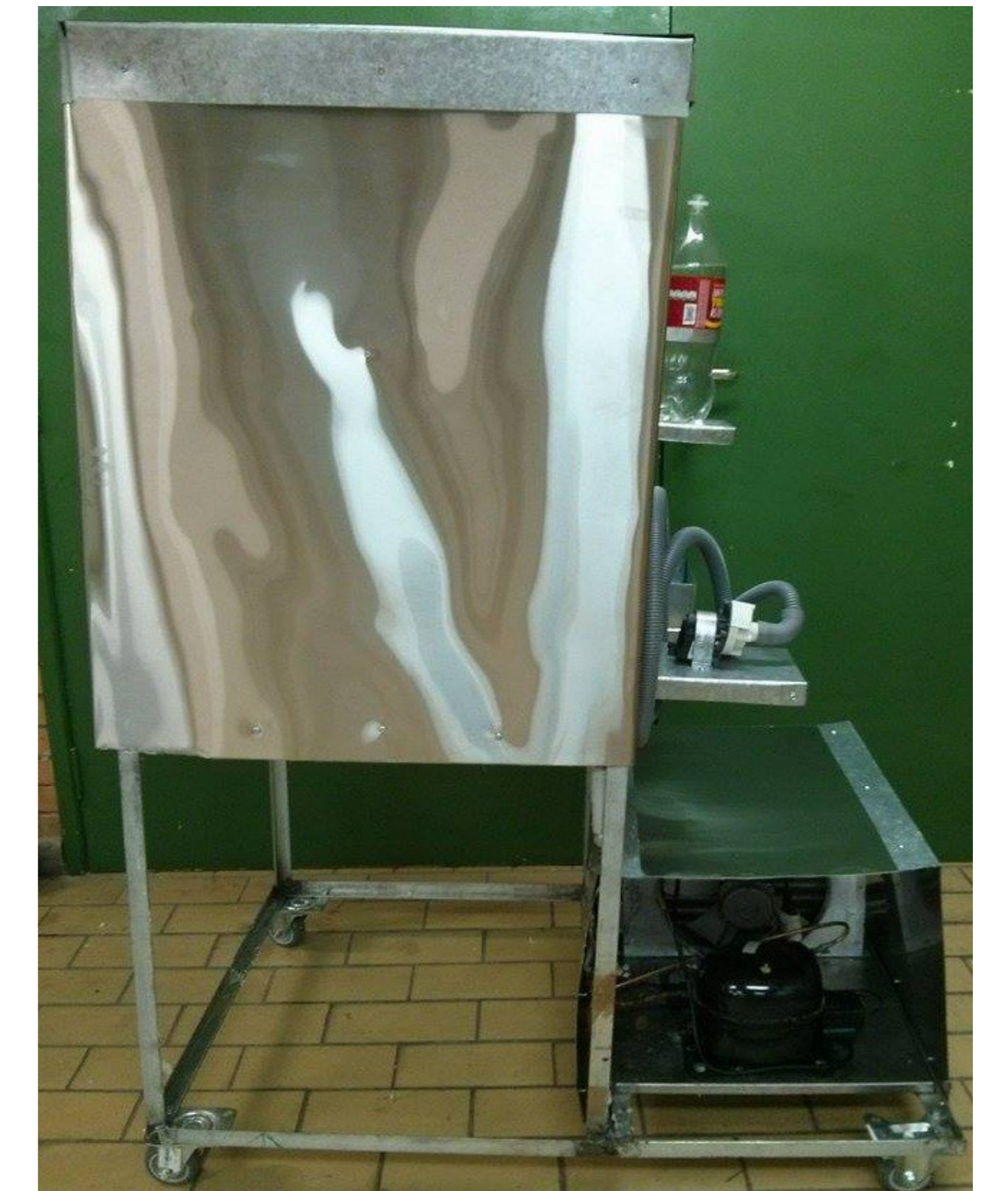
Figura 3 – Imagem do Fermentador/ Maturador refrigerado pronto.
