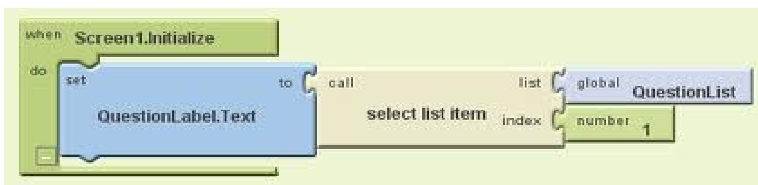
Figura 1 – Blocos utilizados no AppInventor para criar uma função aleatória.
