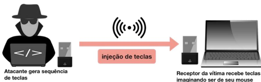
Figura 1. Atacante injetando sequência de comandos no receptor sem fio ligado no computador da vítima.
