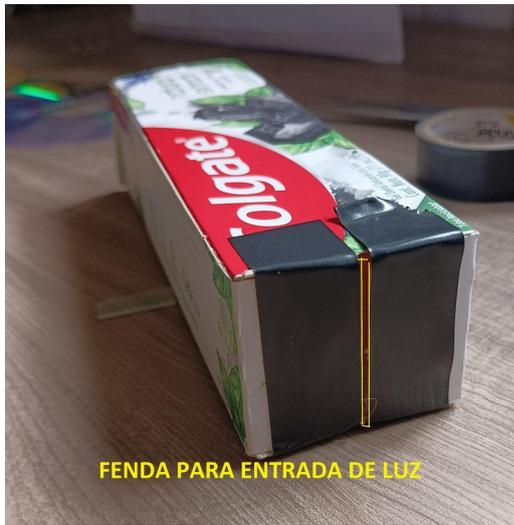
*Construção do espectroscópio caseiro*
