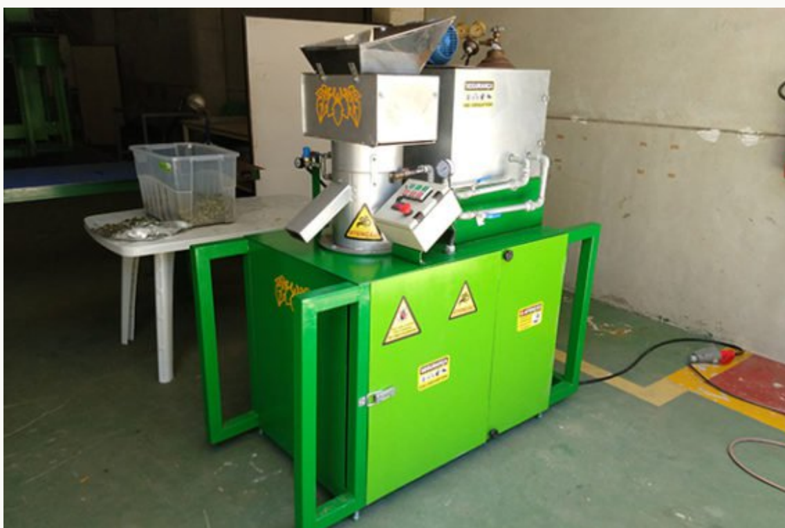
Figura 46. Peletizadora de Lúpulo, capacidade de produção 20 kg/h
