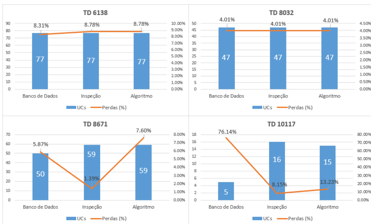
Figura 27 – Balanço energético: UCs e perdas totais (%) por circuito e fonte de dados
